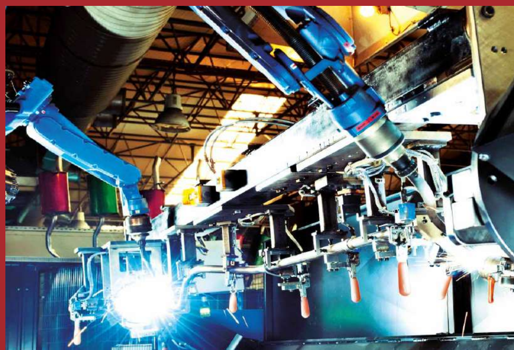
Welding fixture de sujeción manual para proceso de soldadura de estructura tubular
