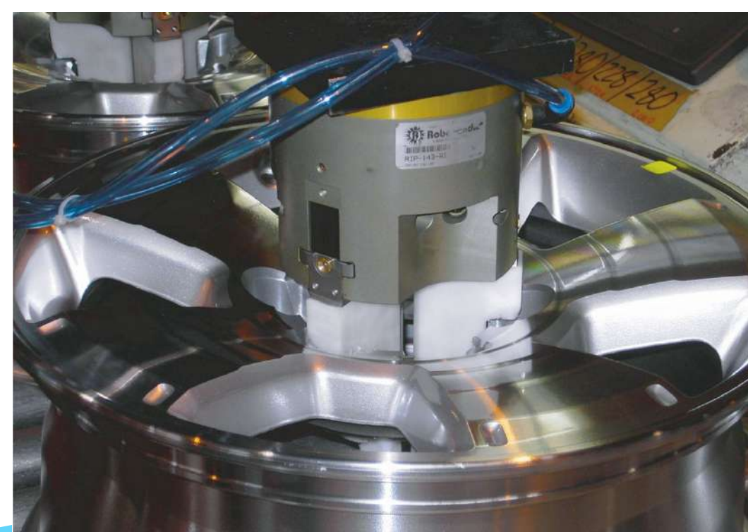
Gripper para aplicaciones de uso pesado multipropósito
