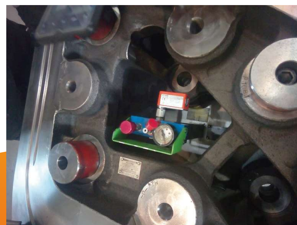
Sistema de monitoreo de presión y temperatura inalámbrico WPM
