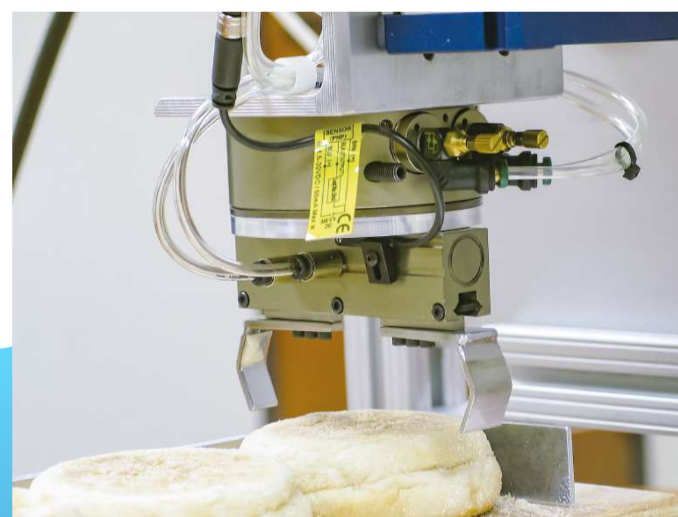
Gripper neumático de uso en la industria alimenticia
