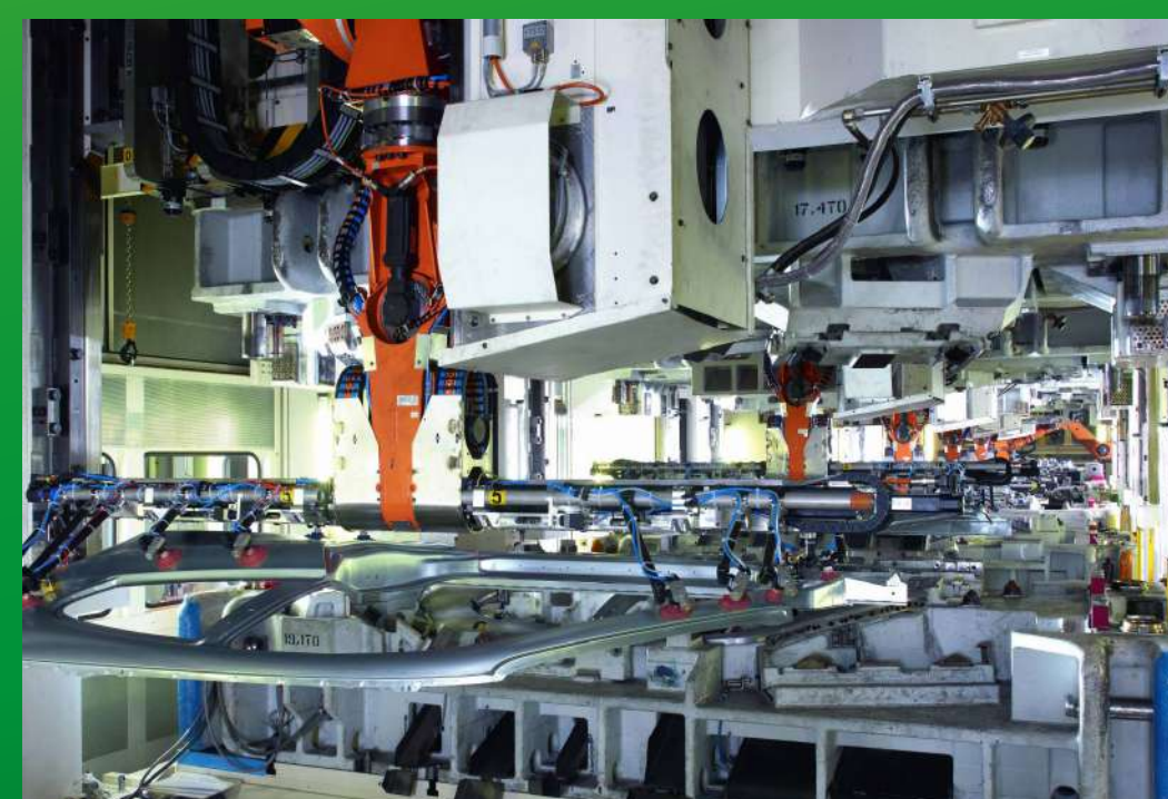
Herramientas Light Weight Tooling (LWT) para prensas Tandem de alta velocidad
