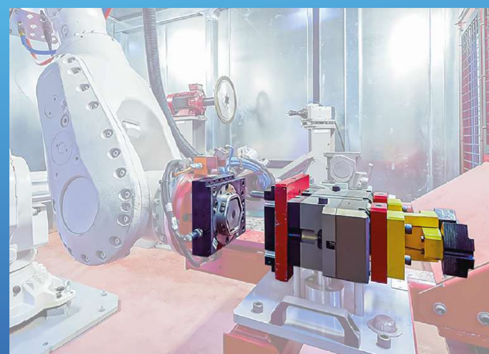
Grippers neumáticos para automatización en áreas de maquinados
