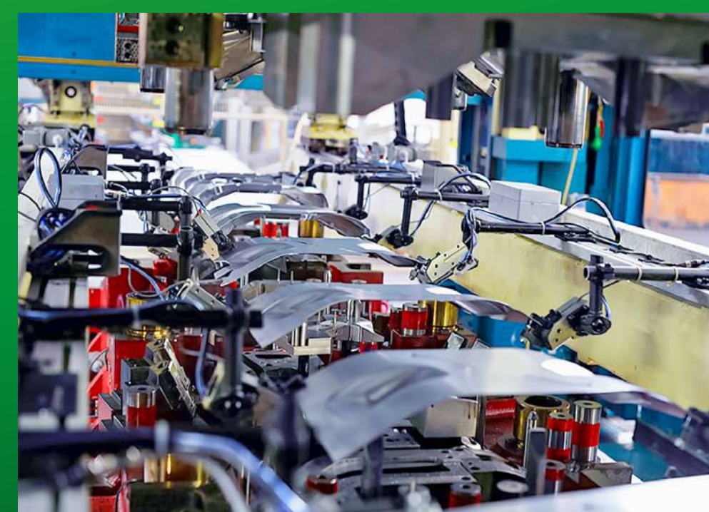
Herramental de riel de tres ejes con grippers para sistemas de transferencia en prensas
