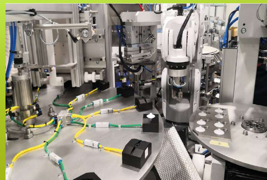
Sistema de montaje con mesas rotativas para manufactura de filtros médicos
