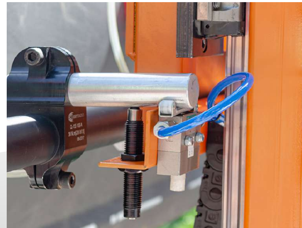
Sistemas de amortiguación, que frena el desplazamiento vertical de un efector final
