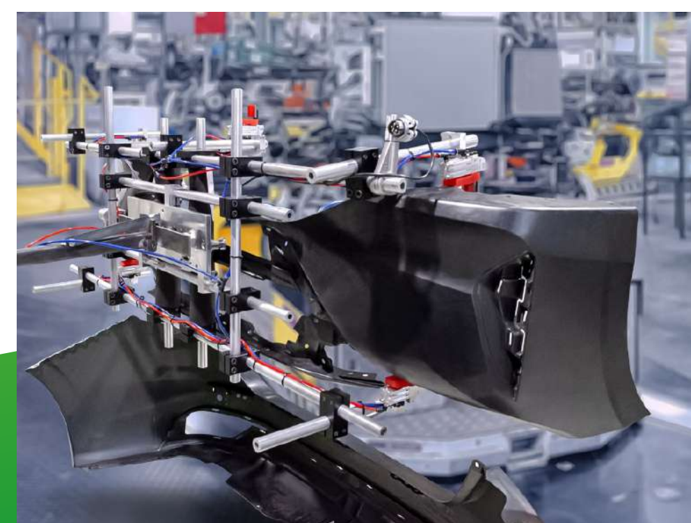
Fin de brazo robótico para extraer defensa en máquina inyectora de plástico
