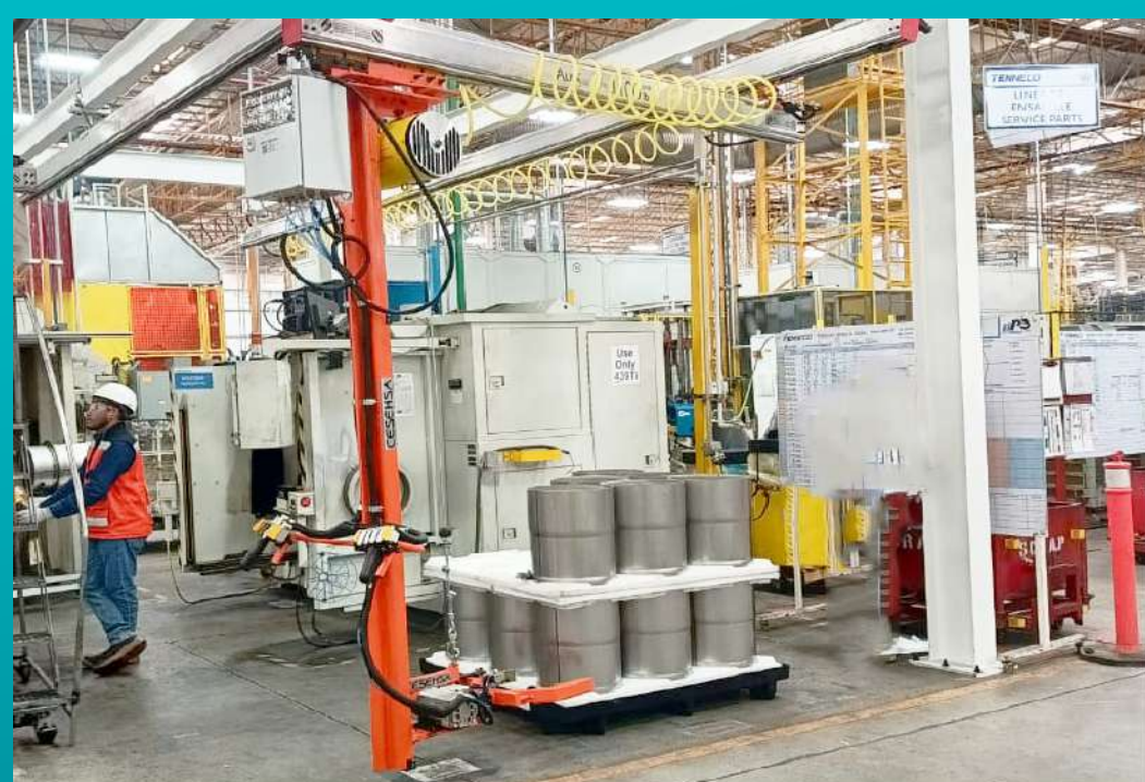
Brazo de carga de catalizadores para cumplimiento de normativas ergonómicas
