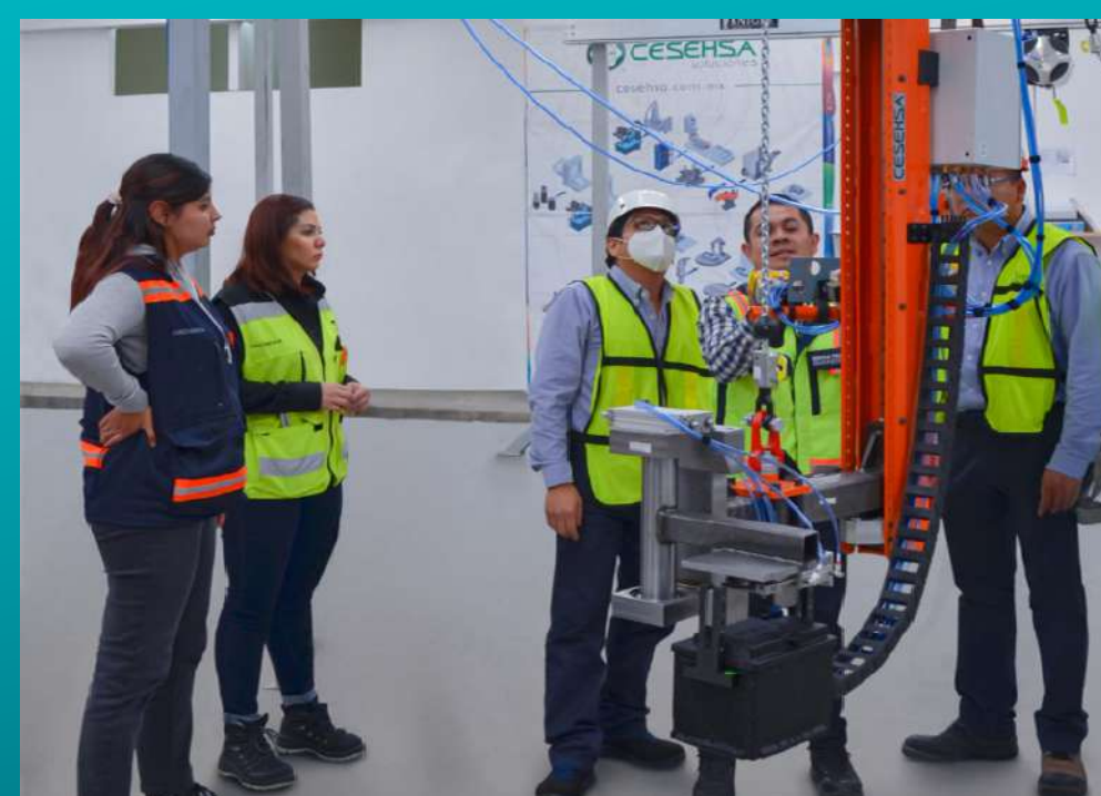
Buy-off validación de brazo de carga de batería para línea de ensamblaje
