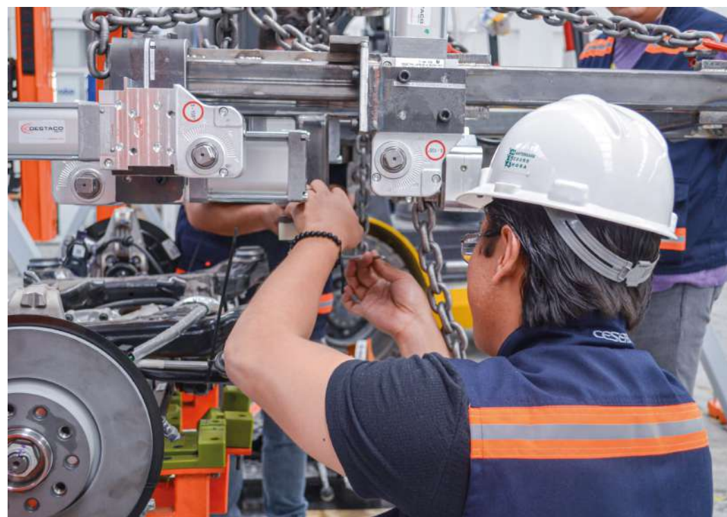
Manipulador de carga con sistema de sujeción por power clamps neumáticos
