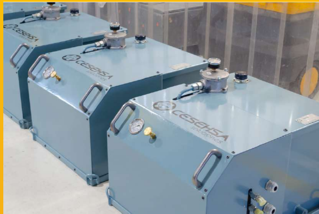
Unidades de potencia con guarda para protección de componentes, requerimiento para hornos oscilantes
