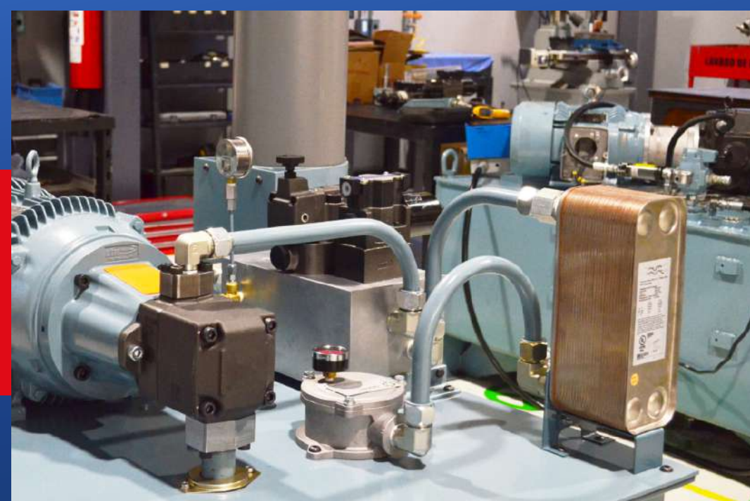
Control de temperatura con intercambiadores de placas soldadas, para unidades de potencia hidráulica
