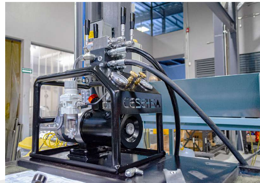
Equipo de amplificación de presión hidroneumático diseñado a la medida
