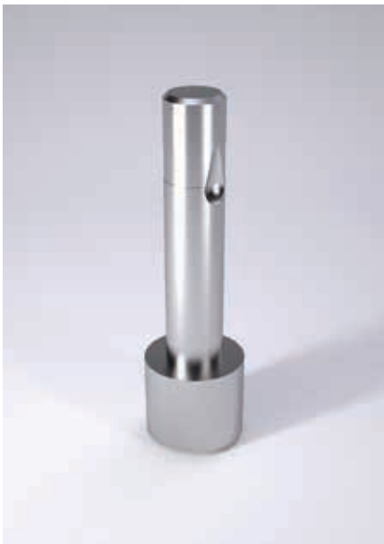
2714. Punzón de corte de cambio rápido, con el diámetro de corte mayor que la caña, redondo, con expulsor, para trabajos ligeros
