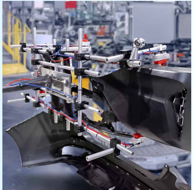
Fin de brazo robótico para extraer defensa en máquina inyectora de plástico
