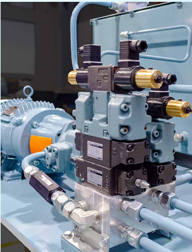
Block hidráulico con válvulas proporcionales para control preciso de flujo y presión
