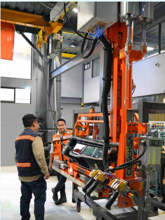
Brazo de carga para manipulación de módulo IP ( consola de control de automóvil )
