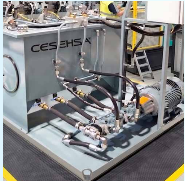
Unidad de potencia hidráulica con bombas triples para máquina de inyección de plástico
