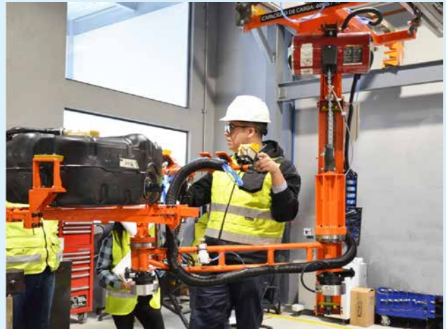
Brazo de asistencia manual para manipulación de tanques en línea de producción
