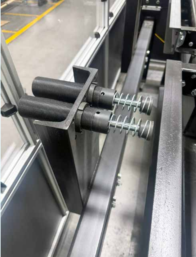
Control en desaceleración y amortiguación para procesos de alimentación de materiales
