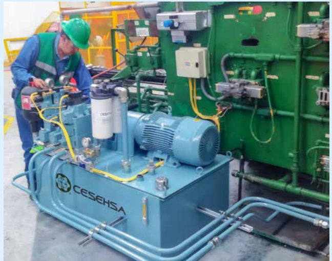
Unidad de potencia hidráulica diseñada a la medida, servicio de instalación y puesta en marcha
