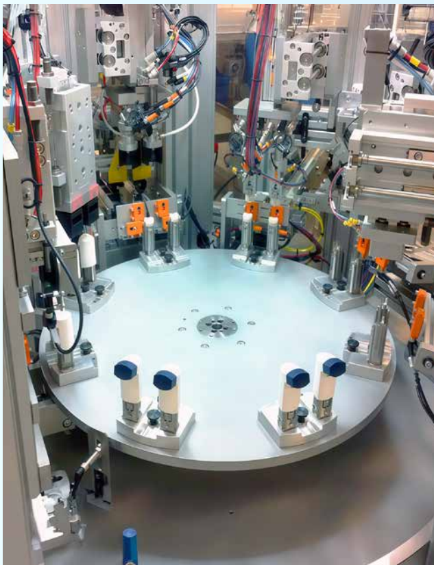
Estación de ensamblaje con mesa rotativa para inhaladores médicos
