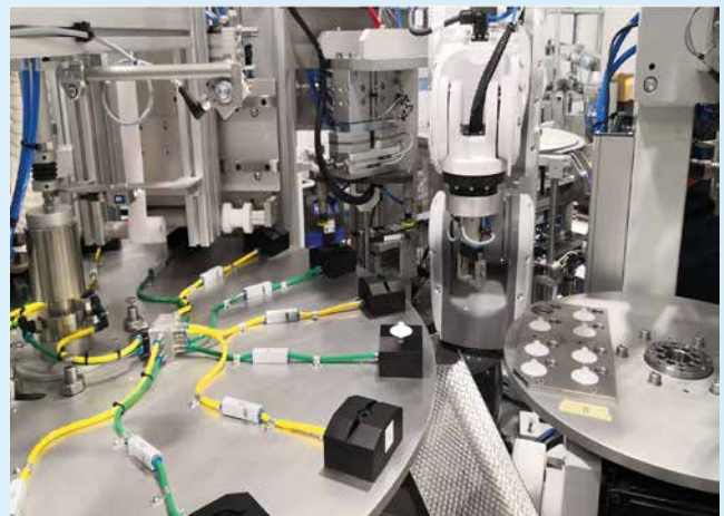
Sistema de montaje con mesas rotativas para manufactura de filtros médicos
