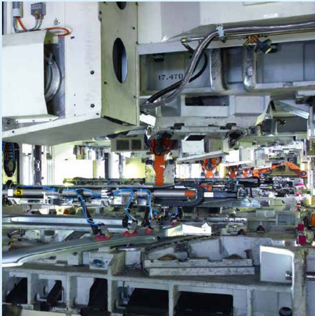
Diseño de sistemas de efectores finales para procesos de estampado de carrocería
