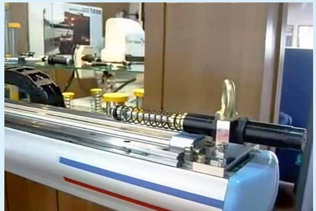
Sistema de frenado en rieles correderas para desplazamiento de cargas de forma segura
