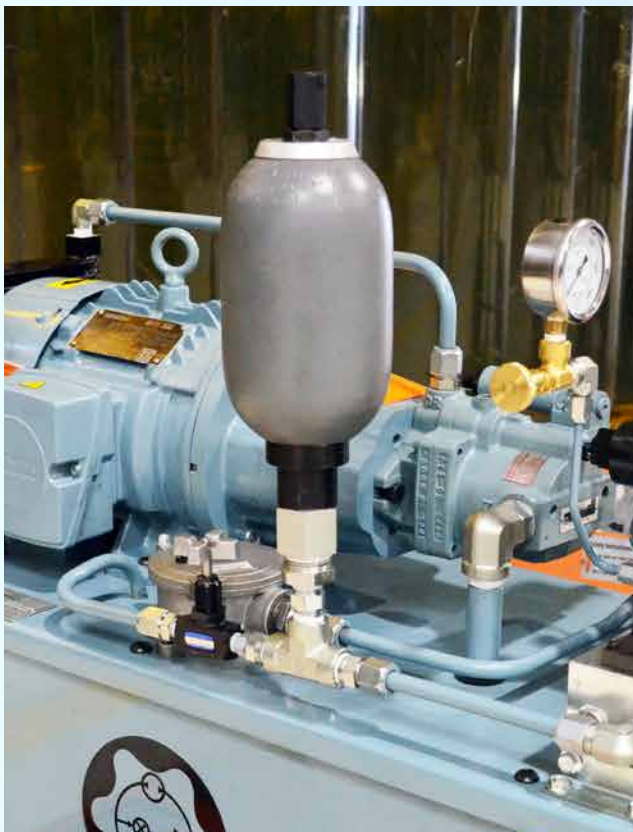
Acumulador para mantener la presión constante en unidades de potencia hidráulica
