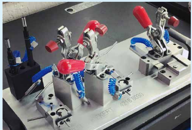
Soluciones checking fixture con clamps verticales
