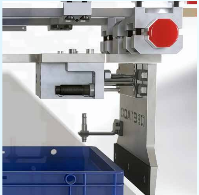
Shock absorber que amortigua el desplazamiento horizontal del gripper durante el cierre
