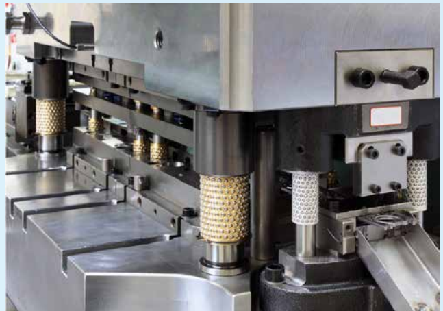
Reemplazo de elementos guía, jaula de bolas, casquillos y columnas para prensa progresiva
