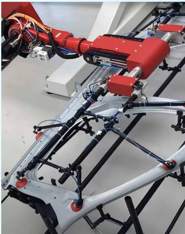
Herramientas Light Weight Tooling (LWT) para prensas Tandem de alta velocidad
