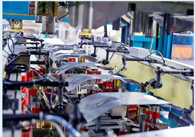
Herramental de riel de tres ejes con grippers para sistemas de transferencia en prensas
