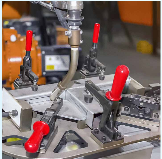
Equipo de sujeción heavy duty para proceso de soldadura MIG automatizado
