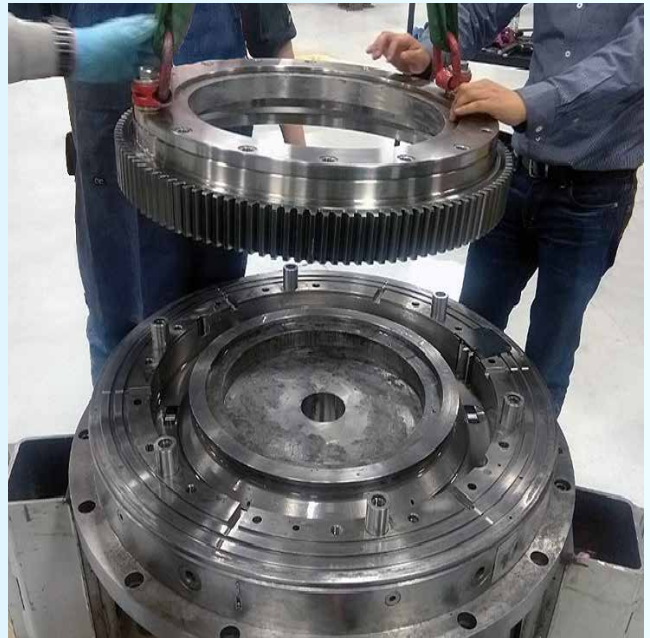
Servicio de mantenimiento general para mesas rotativas
