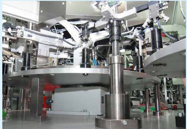
Equipo a la medida para el montaje de o-rings en bombas de combustible
