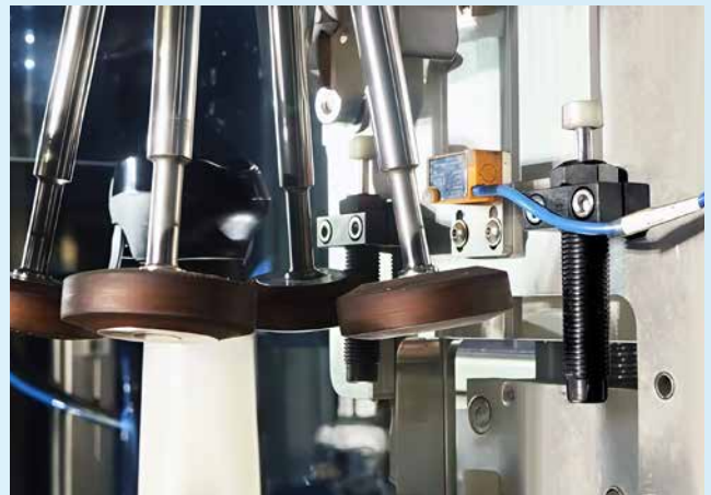
Shock absorbers para frenar actuador lineal, limita el movimiento en la posición final
