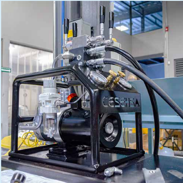
Equipo de amplificación de presión hidroneumático diseñado a la medida
