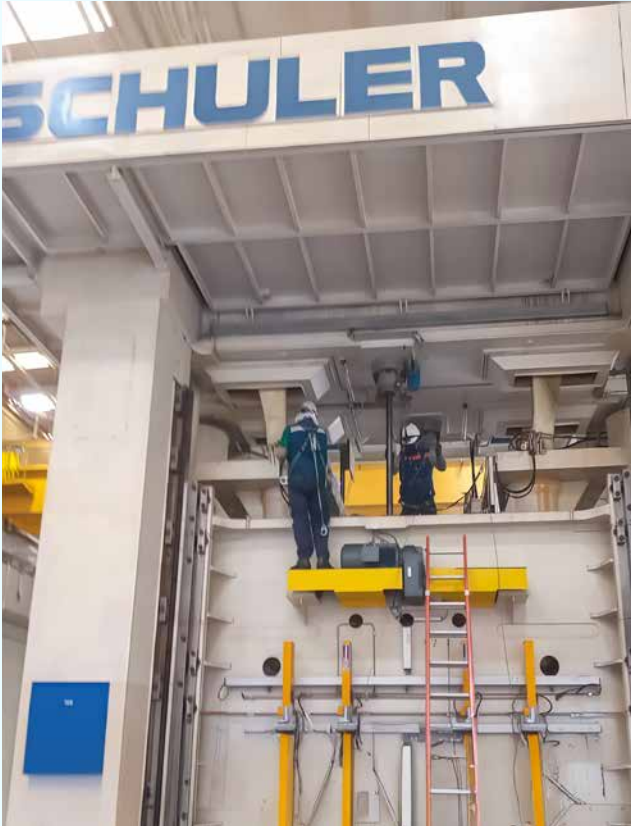
Sistema para monitoreo de tonelaje en prensas
