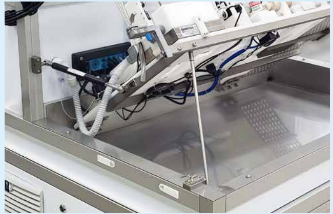
Pull gas springs, eleva la unidad para permitir la limpieza y esterilización por parte del operador
