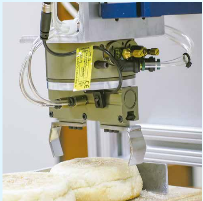
Gripper neumático de uso en la industria alimenticia
