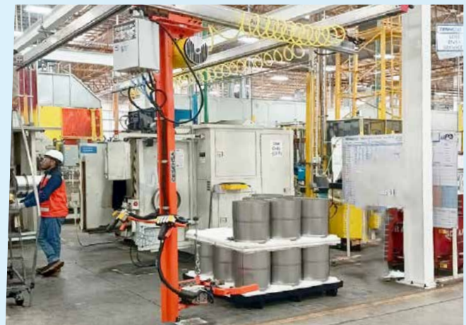
Brazo de carga de catalizadores para cumplimiento de normativas ergonómicas
