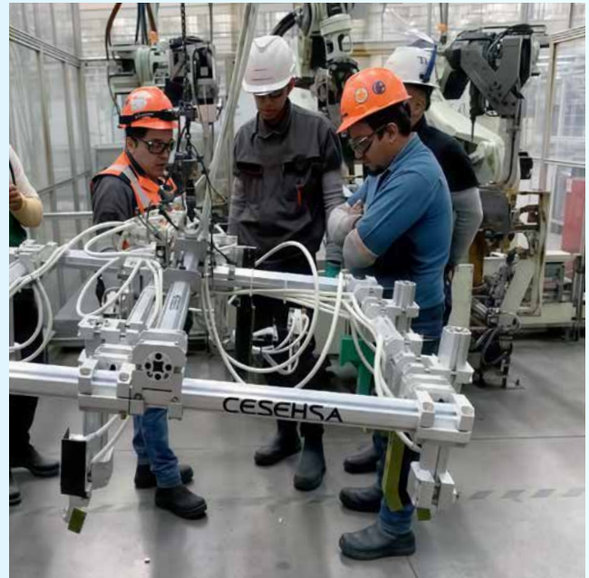
Sistema de carga para el área de soldadura pieza de trabajo: piso de camioneta pick up
