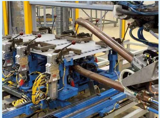
Celda de sujeción para automatización de proceso de soldadura por puntos
