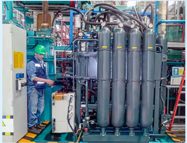
Servicio de mantenimiento y precarga de nitrógeno para acumuladores en máquina inyectora de plástico
