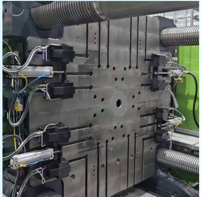
Sistema de cambio rápido para moldes, herramientas y troqueles
