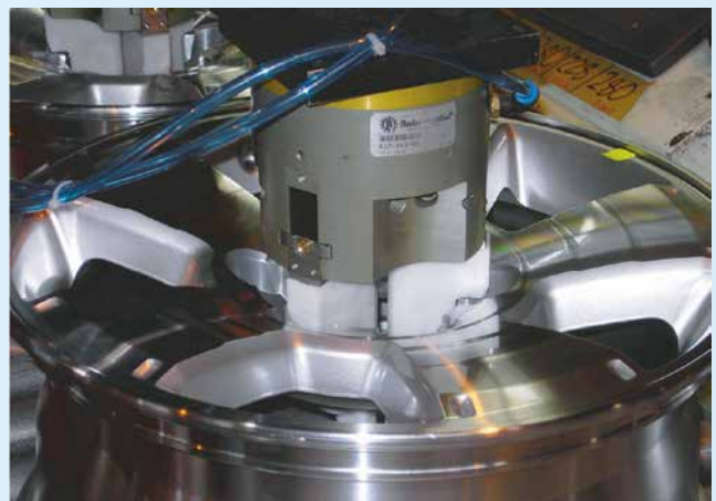
Gripper paralelo de 3 dedos para aplicaciones de uso pesado multipropósito
