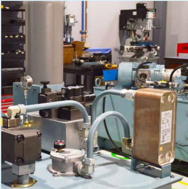
Control de temperatura con intercambiador de placas soldadas, para unidades de potencia hidráulica
