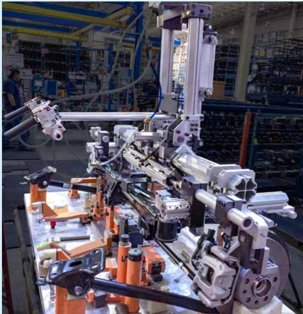
Manipulador de asistencia de carga para sistemas de suspensión y dirección
